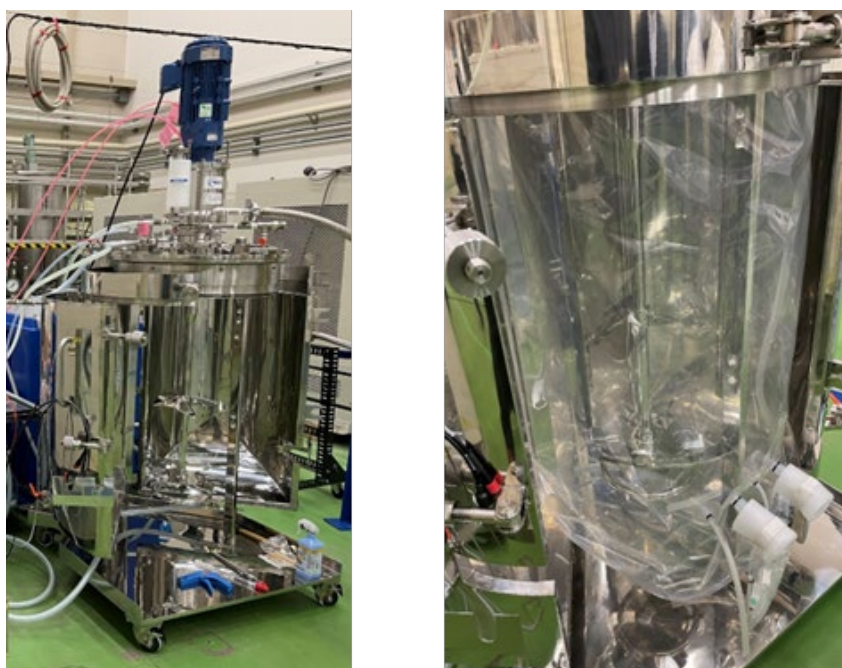
図3 本リアクターの外観(左:シングルユースバック装填前 右:装填後)
